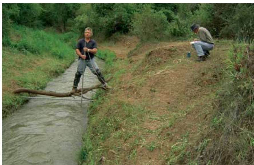
FIGURA 22. Celador aforando canal con un molinete.
