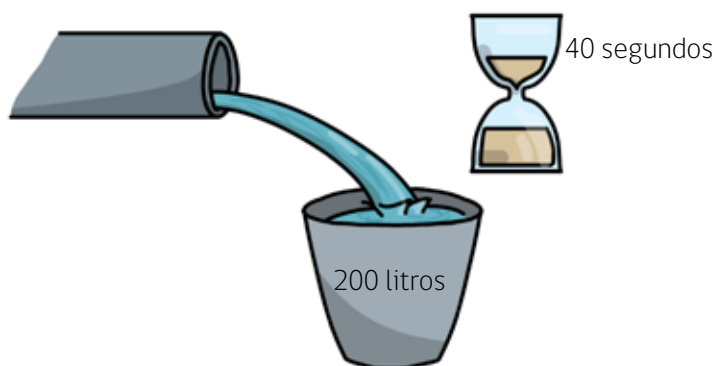
FIGURA 25. Método volumétrico para estimar caudal.
