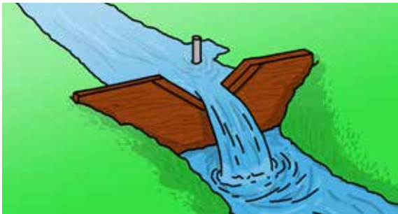
FIGURA 19. Sección de control (vertederos).
